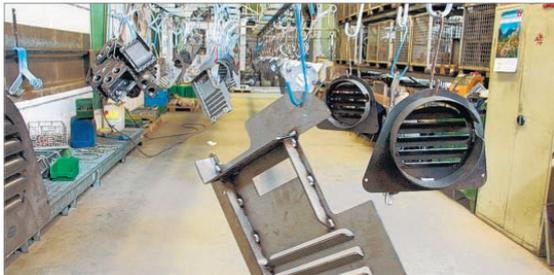
Über eine Hängebahn werden die Produkt-Einzelteile der Waschanlage, der Lackiererei, der Trocknung und den Montageplätzen zugeteilt.
