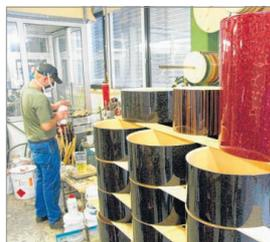
Im Lackierbereich werden unterschiedliche Schlagzeug-Elemente behandelt.
