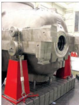
Hier entstehen Gehäuse für Gas- und Dampfturbinen.
