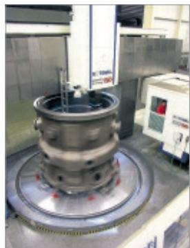
Auch eine moderne Karusselldrehmaschine kommt hier zum Einsatz.
