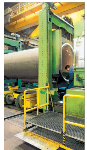
Hier erhalten die Rohre unter fachkundiger Aufsicht den letzten Schliff.
