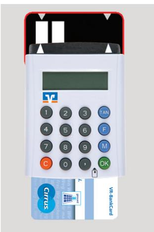
Mögliche Übertragungsstörungen zwischen Monitor und Leser, können in der Regel einfach über eine höhere Helligkeits-Einstellung am Monitor behoben werden.
