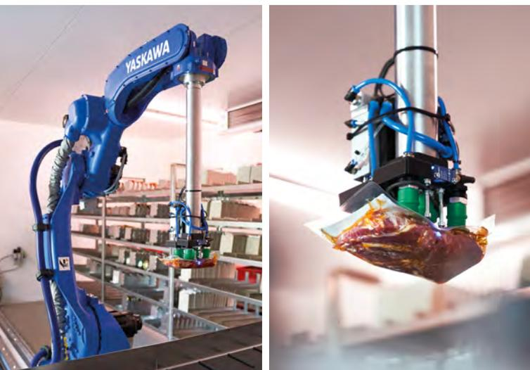
Über Vakuumsensoren nimmt Roberta die Ware auf und befördert sie zuverlässig in die Ausgabeklappe.
