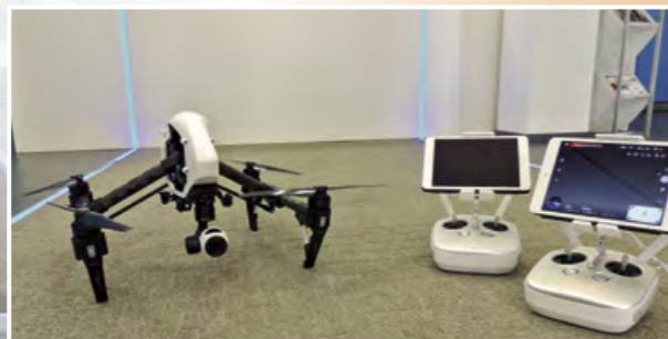
Das Modell DJI Inspire 1 wiegt nur knapp drei Kilogramm, kann bis zu 22 Meter pro Sekunde zurücklegen und eine Flughöhe von 4.500 Metern erreichen.
