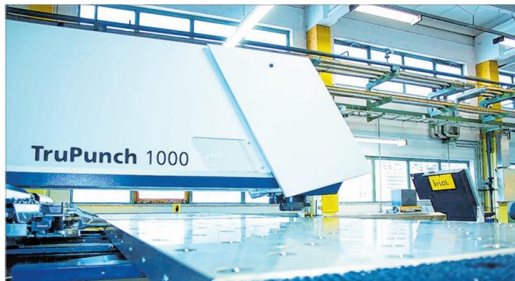
Die Stanzmaschine kann präzise Stanzungen in Metallplatten machen. Für gewisse Produkte von Dachtechnik Briel ist das notwendig, um spezielle Lochbilder abbilden zu können. Ähnlich wie ein Laserschneider kann sie unterschiedliche Materialien schneiden.
