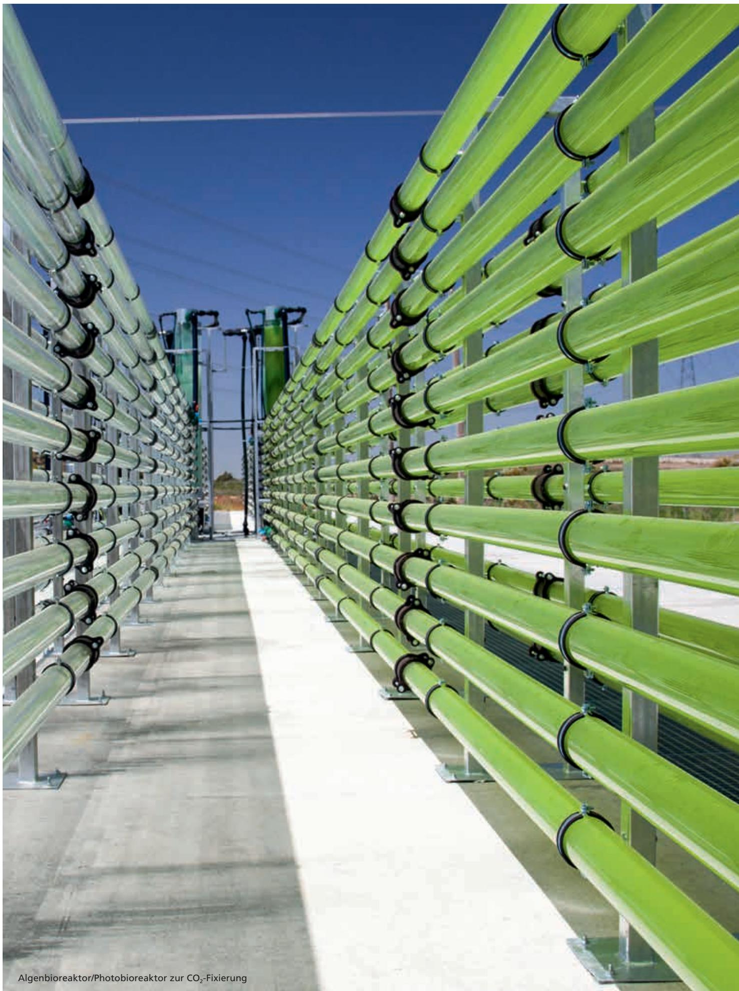
Algenbioreaktor/Photobioreaktor zur CO<sub>2</sub>-Fixierung
