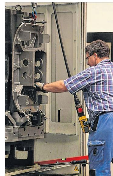
Ein normaler Arbeitsgang. Das Bauteil – in dem Fall die Bodenplatte für eine Rüttelplatte – wird von Achim Bernshausen mit dem Kran angehoben (linkes Bild), zur Maschine befördert (mittleres Bild), in diese eingespannt (rechtes Bild) und schließlich von der 4-Achs-Fräse nach den Vorgaben des Kunden bearbeitet.
