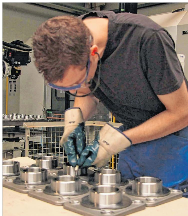
Den letzten Feinschliff bekommen die Bauteile bei Bedarf manuell. Anschließend sind die Werkstücke montagefertig.
