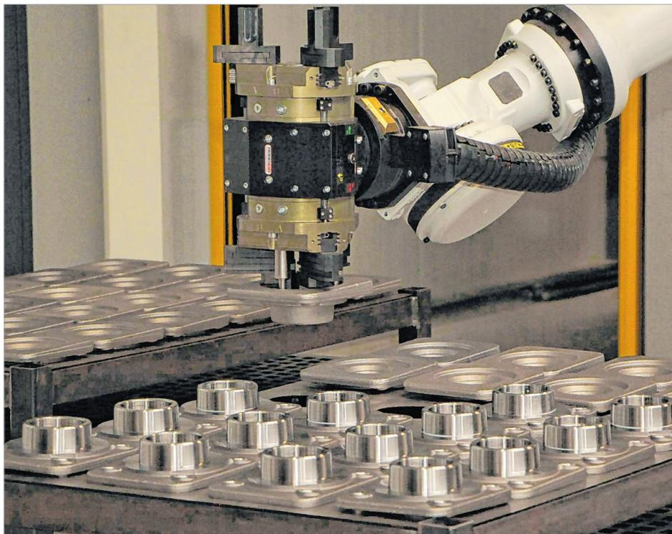
Ein Roboterarm bestückt die CNC-Maschine mit den Rohbauteilen und nimmt die fertig bearbeiteten Teile wieder aus der Maschine heraus. Alles läuft vollautomatisiert.
