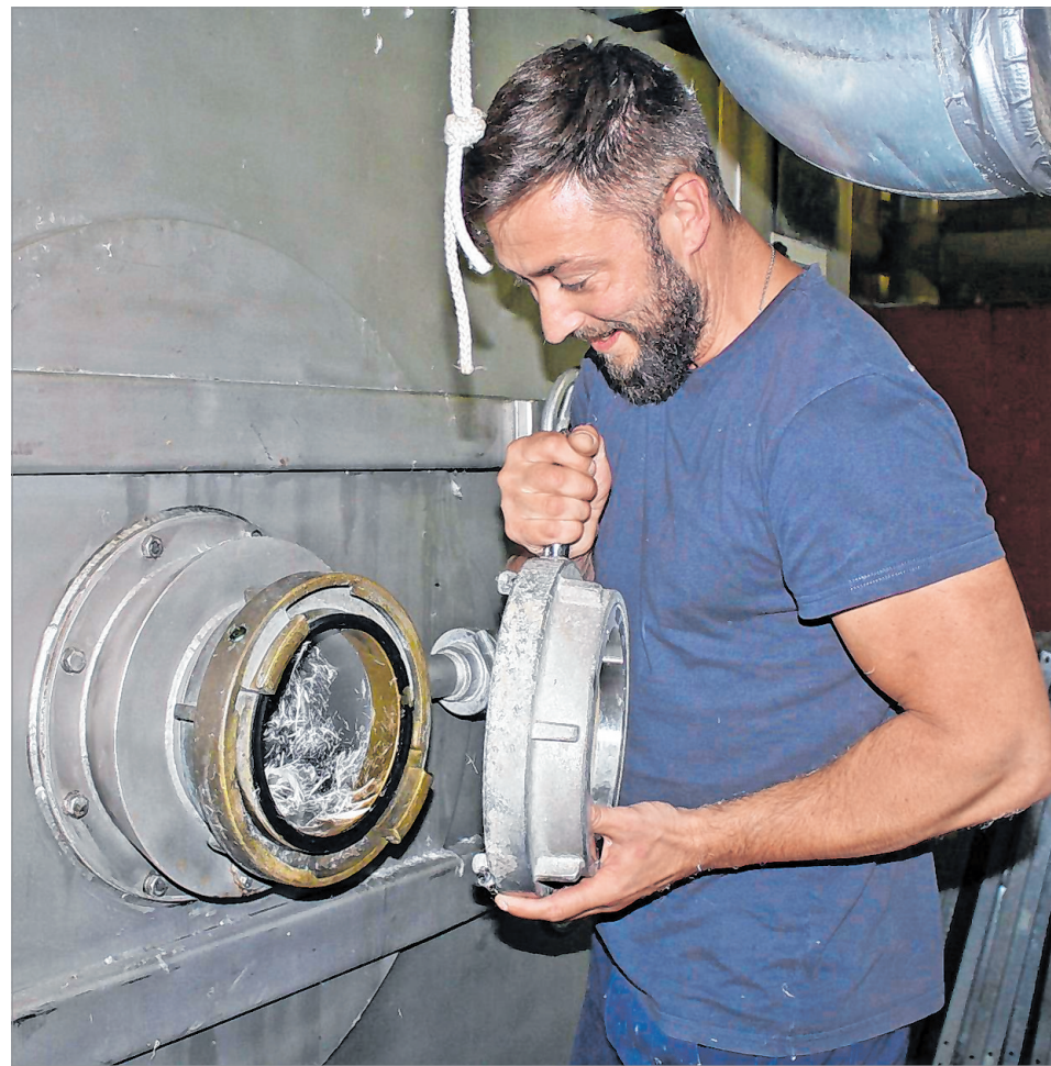
Mitarbeiter Marcel Blanke bedient hier die vollautomatische Waschmaschine. Die wäscht und schleudert das Rohmaterial.
