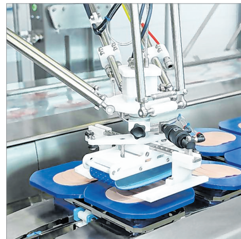
Voll automatisiert werden die Portionen per Greifarm in die Verpackung gehoben.
